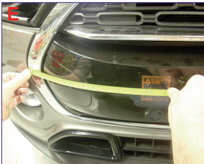
La misura tra il bordo della mascherina e il centro capsula deve essere di 295 mm.
