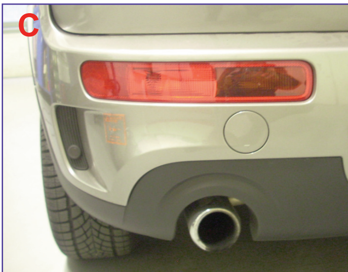
La misura tra il bordo del tappo tondo e il centro capsula deve essere di 180 mm.
