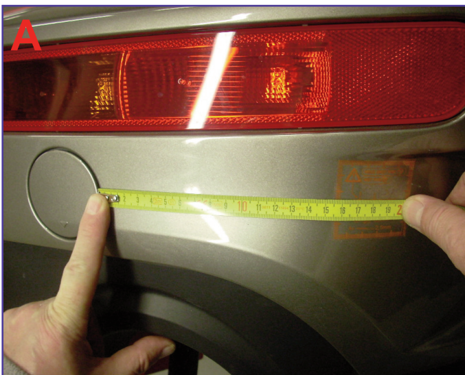
La misura tra il bordo del tappo tondo e il centro capsula deve essere di 180 mm.
