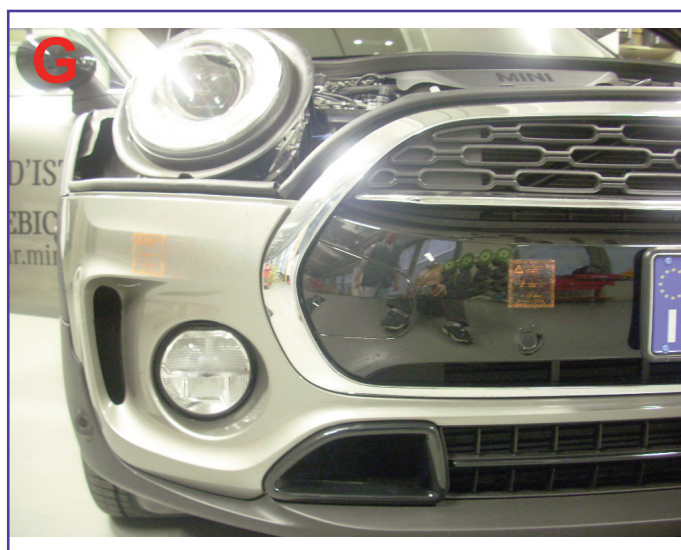
La misura tra il bordo della mascherina e il centro capsula deve essere di 295 mm.
