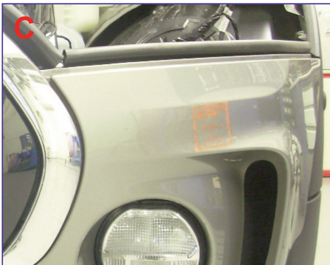
La misura tra il bordo e il centro capsula deve essere di 150 mm.
