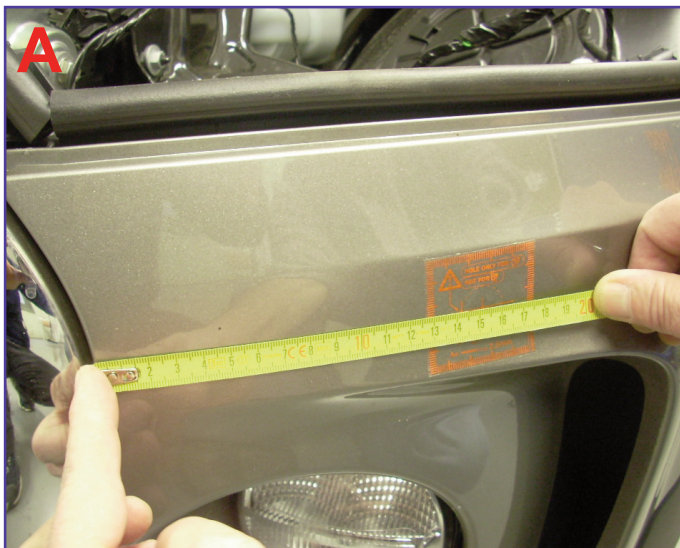
La misura tra il bordo e il centro capsula deve essere di 150 mm.
